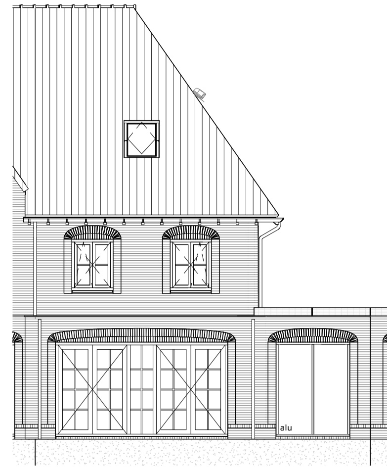
Uitbouw 1200mm en vergrootte pui. getekend : bwnr 11, 15, 17 gespiegeld : bwnr 12, 16
